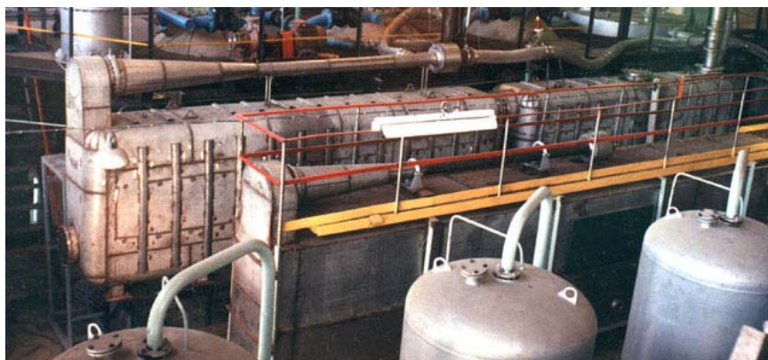
Рис. 2 Контактная камера производительностью по воде 10000 м 3 /сут.
