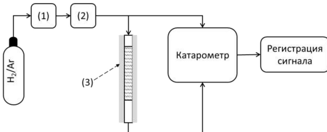
**Рис. 13.2.** Схема установки для проведения ТПВ: 1 - система очистки газов, 2 – блок регулировки расхода газов, 3 –печь с реактором.
