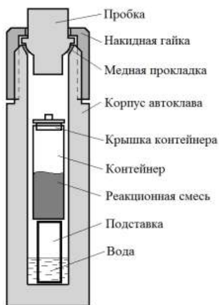
Рис. 11.2. Схема автоклава.
