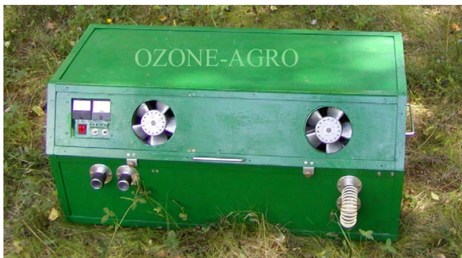
Рис. 3. Озонаторная установка «OZONE-AGRO 50».
